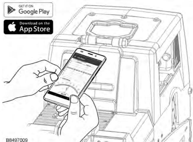
Con la aplicación de servicio de Ammann puede acceder a los datos de ServiceLink de todas las máquinas en el entorno de su red inalámbrica o Bluetooth LE. Además, puede introducir en la aplicación la información de servicio y mantenimiento y las operaciones que deba realizar en cada máquina, así como completarla y almacenarla directamente en el software de ServiceLink de la máquina.
